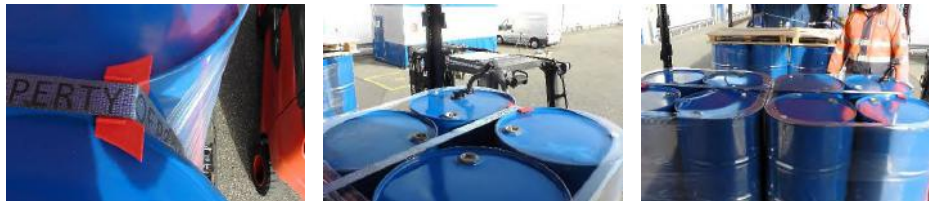
Sicherung der Fässer / drum securing
