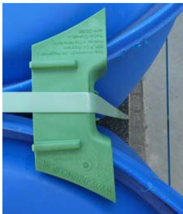
Figuur 23: DRUMCLIP DC19B GREEN gezekerd met Signode Tenax T2220 Polyester strap
