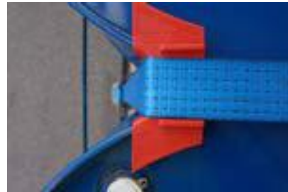
Spanngurt mittig auf äußeren Drumclip; Spanngurt hinter dem horizontalen Strap / Lashing belt centered on outer Drumclip; lashing belt behind the horizontal strap
