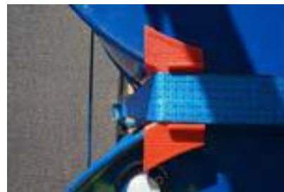
Spanngurt mittig auf äußerem Drumclip, Spanngurt hinter dem horizontalen Strap / Lashing belt centered on outer drum clip, lashing belt behind the horizontal strap
