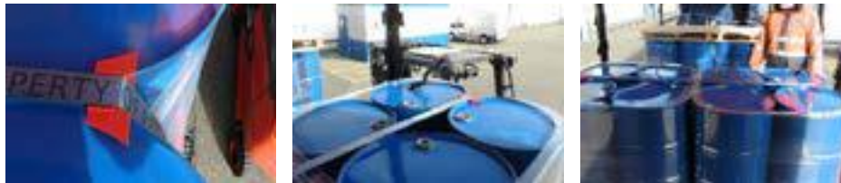
Sicherung der Fässer / drum securing
