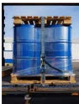
Variante 2 mit Paletten, maschinell gewickelt / *Variant 2 with pallets, machine-wrapped*
