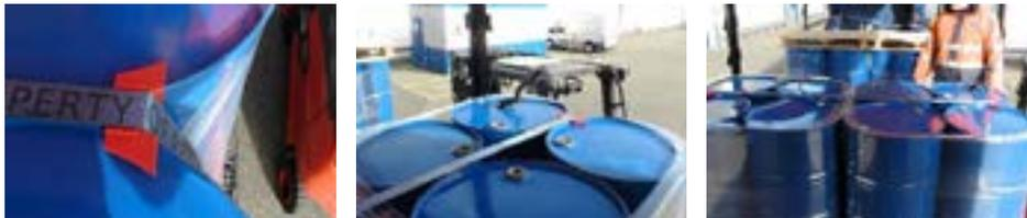
Sicherung der Fässer / drum securing
