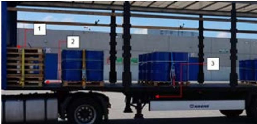
Positionen der Beschleunigungssensoren / Positions of the acceleration sensors:
