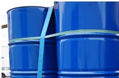
Variante 5b: Spanngurtverlauf **über** den Strap /
