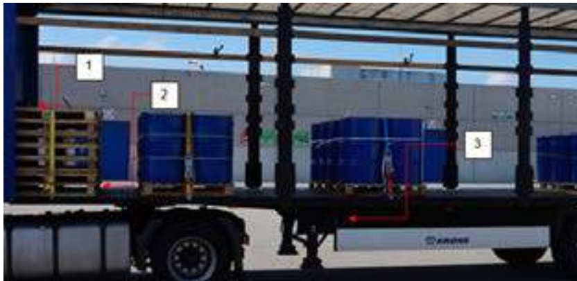
Positionen der Beschleunigungssensoren / Positions of the acceleration sensors:
