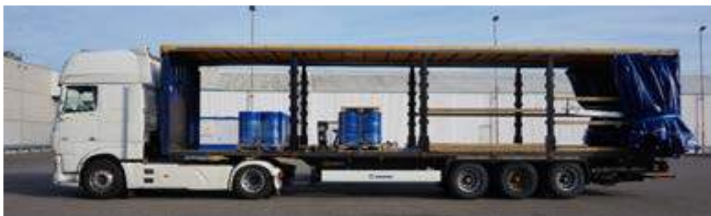
Sattelzug in Rotterdam, hier mit Sicherungsvariante 1 & 2 beladen / Semitrailer truck in Rotterdam, here loaded with safety variant 1 & 2
