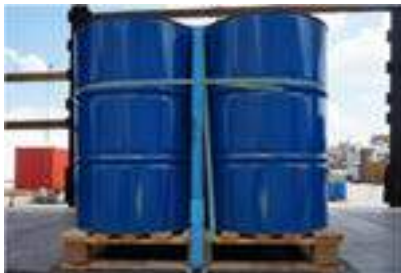
Horizontaler und vertikaler Strap, Spanngurt hinter dem horizontalen Strap / Horizontal and vertical strap, lashing belt behind the horizontal strap
