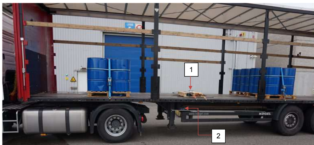
Positionen der Messeinrichtungen / Positions of the measuring instruments: 1. SAVER9X GPS ; 2. VBOX 3i
