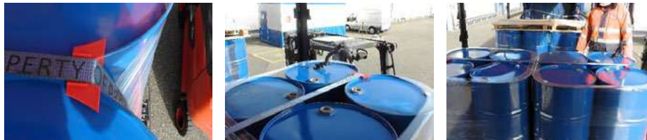
Sicherung der Fässer / drum securing
