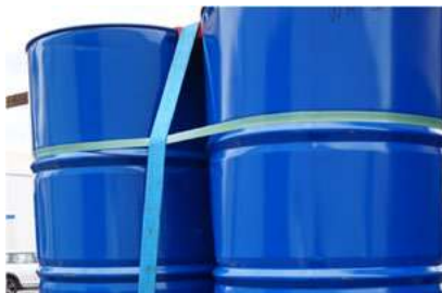
Variante 5b: Spanngurtverlauf über den Strap / Variant 5b: Course of lashing belt over the strap
